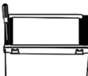
12. Bringen Sie die obere Abdeckung wieder an und befestigen Sie sie mit 2 Schrauben auf der Rückseite. Montieren Sie den Türaußengriff (falls vorhanden)
