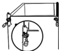
10. Bringen Sie das Tretlager und den Scharnierstift wieder an. Ersetzen Sie beide verstellbaren FüÙe.
