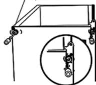
8. Schrauben Sie das untere Scharnier ab. Entfernen Sie dann die verstellbaren Füße auf beiden Seiten.
