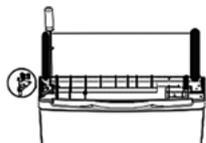
11. Heben Sie die Tür wieder an. Stellen Sie sicher, dass die Tür horizontal und vertikal ausgerichtet ist, damit die Dichtungen allseitig schließen, bevor Sie das obere Scharnier endgültig festziehen.
