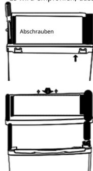
1. Entfernen Sie die beiden Schrauben an der Rückseite der oberen Abdeckung.
