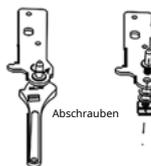
9. Lösen und entfernen Sie den unteren Scharnierstift, drehen Sie die Halterung um und bringen Sie sie wieder an.
