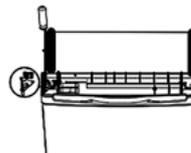
7. Drehen Sie die Tür des Gefrierschranks und platzieren Sie das Scharnier auf der linken Seite. Befestigen Sie dann die Tür auf dem Halter.
