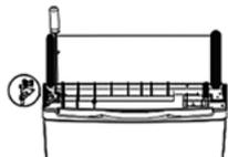
**11.** Remontez la porte. Assurez-vous que la porte est alignée horizontalement et verticalement, de sorte que les joints se ferment de tous les côtés avant de finalement serrer la charnière supérieure.
