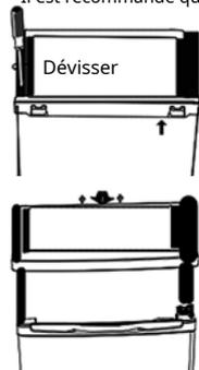
1. Retirez les deux vis à l'arrière du capot supérieur.
