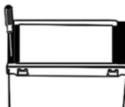
**12.** Remplacez le capot supérieur et fixez-le avec 2 vis à l'arrière. Installer la poignée de porte extérieure (si présente)
