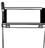
8. Volte a instalar a cobertura superior e fixe-a com 2 parafusos na parte traseira.
